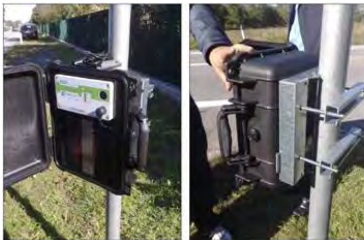
Figura 85 – Radar SDR-EasyData – Esempio di installazione
