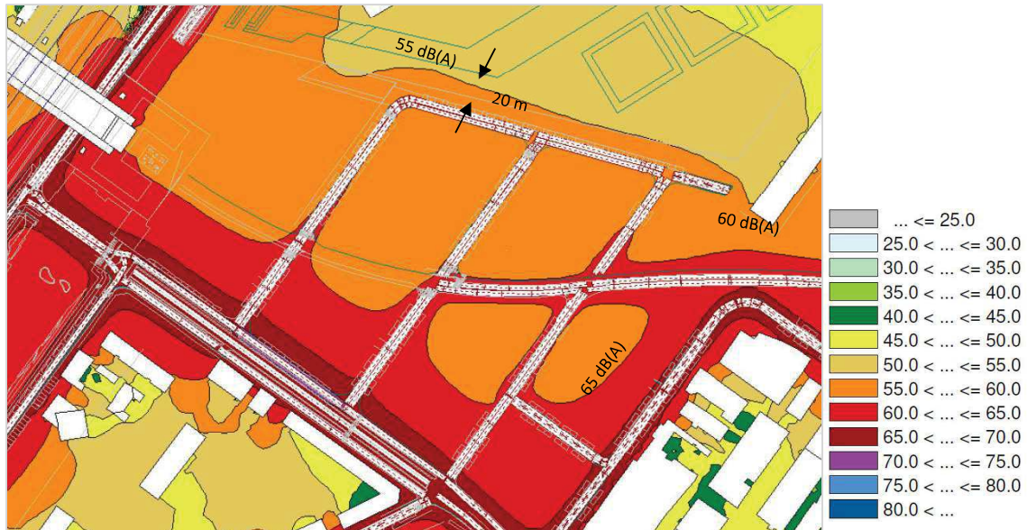
Figura 4-5: Livelli sonori previsionali in periodo diurno – scenario di intervento senza edifici di progetto (lo scenario considera la posa di asfalto fonoassorbente lungo tutta la viabilità simulata e l'introduzione di una zona a velocità 30 km/h lungo la diagonale e la viabilità locale di quartiere (side-streets e strada parco)
